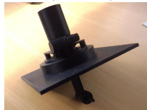
Printet model af det roterbare sejldrev
